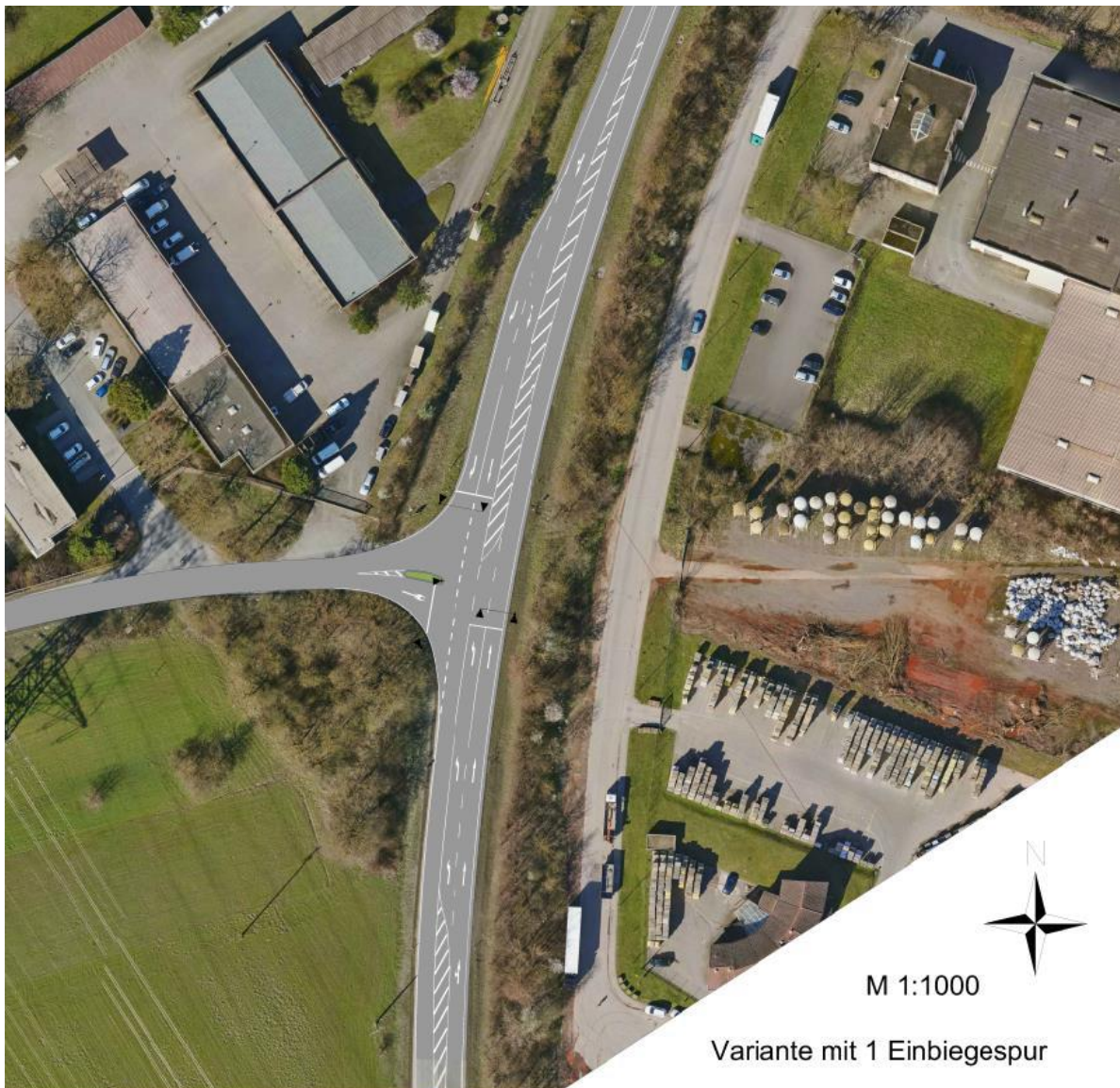
Abbildung 32: KP 1; Untervariante a) mit Mischfahrstreifen in der untergeordneten Zufahrt (Quelle: Schweitzer GmbH)
