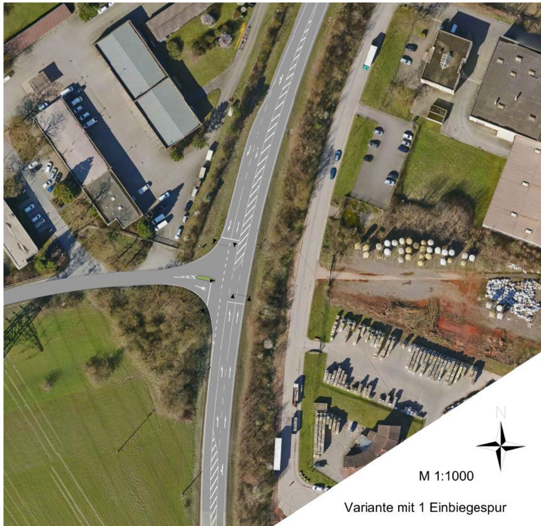
Abbildung 17: KP 1; Untervariante a) mit Mischfahrstreifen in der untergeordneten Zufahrt
