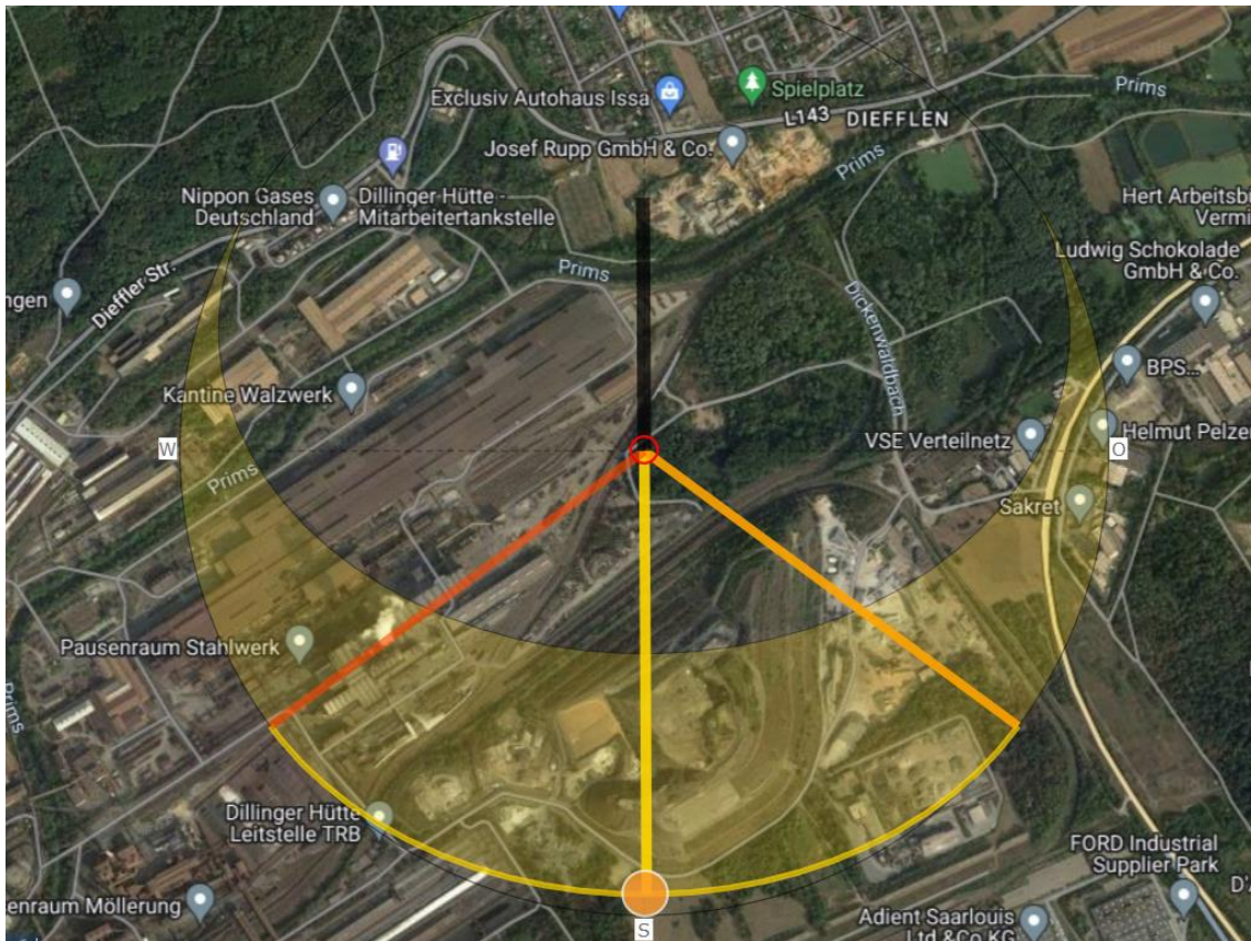
Abbildung 2: Schattenwurf am 21.12. um 12:30 Uhr 30 (schwarzer Balken). Das Dreieck zwischen oranger und roter Linie zeigt den Sonnenverlauf zwischen Sonnenauf- und -untergang).
